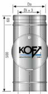
Reinigungselement mit Deckel
