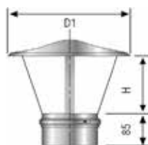
Regenhaube mit Verbindungsschelle für Mündungsabschluß
