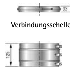
Verbindungsschelle 125 mm, mit 3 Verschlüssen
