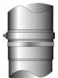
Muffenbindung Dichtung in der Muffe
