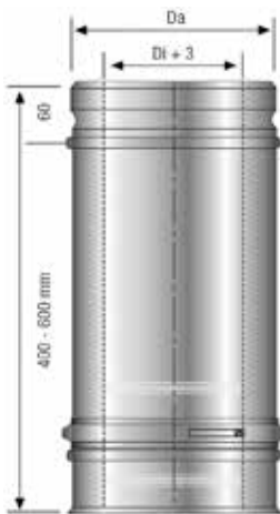
Längenausgleichselement 400 – 600 mm
