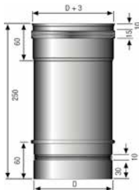
Passelement 250 mm mit Doppeldichtung
