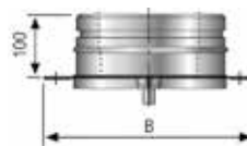
Basisplatte mit Kondensatablauf
