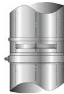
Muffenverbindung mit schmaler Verbindungsschelle
