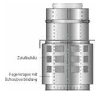
Basisplatte für Luftansaugung Steckverbindung weit/eng – eng/weit
