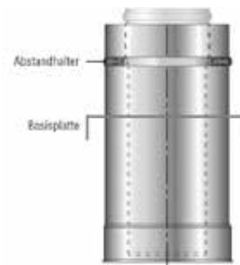
Basisplatte offen Steckverbindung weit/eng – eng/weit
